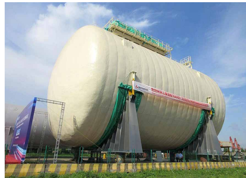
LNG fuel tank
